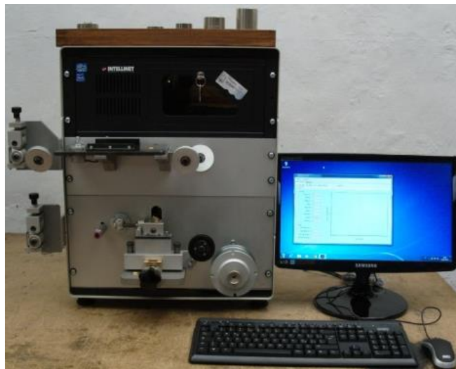
mod. SST2 (IEC 60851-3.B3/B4, NEMA MW 750)
