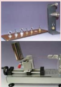
E1 Elettrodo adatto per diametri < 0.10 mm (38AWG), complete di set di pesi.
